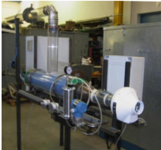
Esso non rappresenta la configurazione dell'impianto finale, il quale andrà integrato nell'impianto realizzando le possibili sinergie con le funzioni impiantistiche della caldaia, ma ne realizza tutti i principi di funzionamento, essendo stato sviluppato al fine di compiere una campagna sperimentale volta alla determinazione delle proprietà termodinamiche e operative del sistema ed è, quindi, stato realizzato per evidenziare i parametri sperimentali ed operativi.
