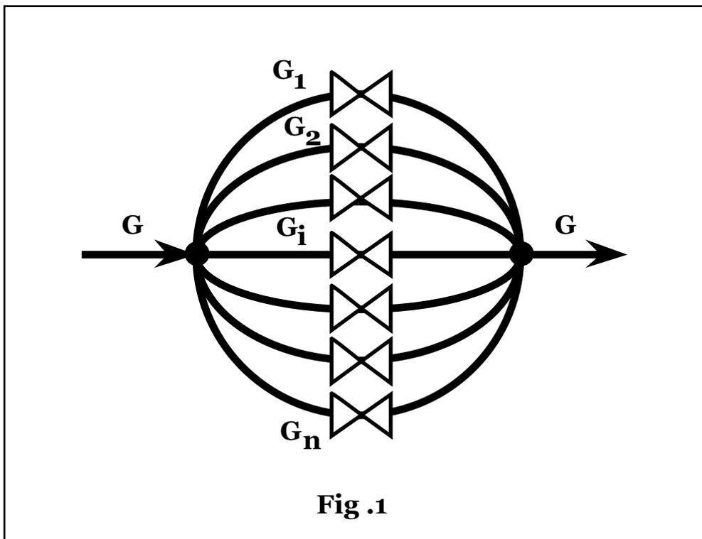
Il diametro di una tubazione semplice equivalente alla serie delle tubazioni in parallelo, ( $\mathbf{D_{eq}}$ ), di lunghezza  $\mathbf{L_0}$ , si ottiene dalla relazione:
