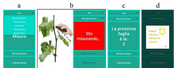
Fig. 1 - Screenshot dell'app PocketSTRESS che ne illustrano il funzionamento: (a) scelta della varietà, (b) scansione della foglia, (c) conteggio del numero di foglie scansionate, (d) visualizzazione del livello di stress idrico.
