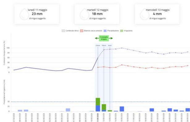
Fig. 4 - Output del modello SWAB sulla piattaforma IRRITRE, : andamento del contenuto idrico del terreno con consiglio irriguo (linea blu) e senza consiglio irriguo (linea rossa). Le barre in basso mostrano le precipitazioni (blu) e le irrigazioni (verde)
