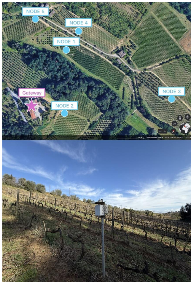
Fig. 1 - Distribuzione spaziale dei nodi e del gateway nell'area di studio (in alto) ed immagine del nodo di monitoraggio installato in un vigneto (in basso).
