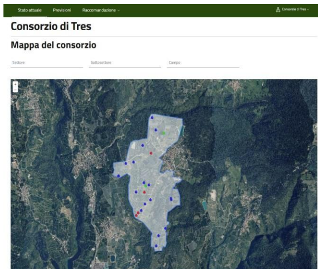
Fig. 3 - Mappa del consorzio di Tres con i simboli dei sensori colorati in base allo stato idrico del suolo (Schermata della piattaforma IRRITRE).
