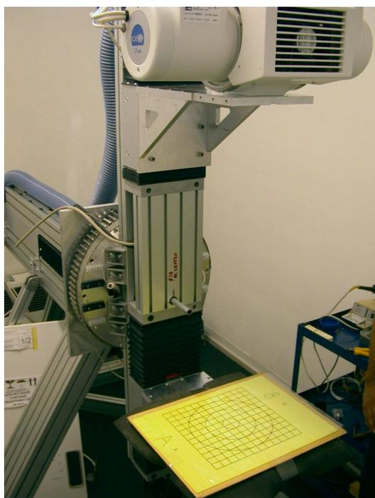
Fig. 5: Foto del sistema CT in cui si evidenziano il braccio rotante con il tubo radiogeno e il supporto per il rivelatore. Attualmente il monocromatore è in fase di caratterizzazione. Si può vedere il tubo di supporto per l'animale, entro tale tubo scorreranno i gas (ossigeno, anestetico, aria calda) per il supporto vitale del topo.
