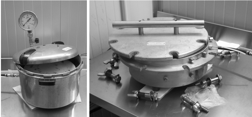
Figura 6.10: - Modelli di camera di Richards utilizzati per la determinazione dei punti a potenziale più basso (alto in valore assoluto) della curva di ritenzione.
