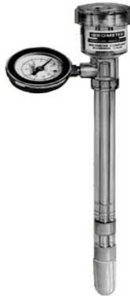
Figura 6.8: - Tipico tensiometro utilizzato in campo
