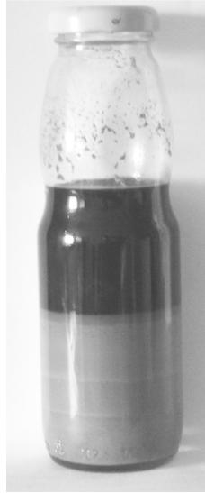
Figura 3.6: - Dispersione di un terreno dopo sedimentazione in un contenitore cilindrico
