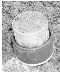
Figura 2.3: Campione di terreno prelevato con cilindretto
