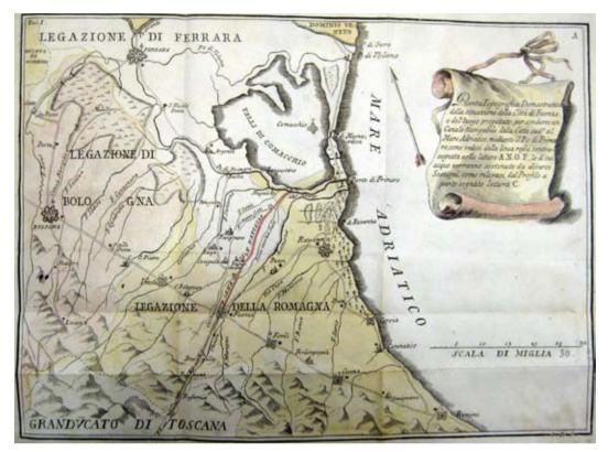
Fig. 6 – Pianta Topografica Demostrativa della situazione della Città di Faenza, e del luogo progettato per condurre un Canale Navigabile dalla Città suddetta al Mare Adriatico, mediante il Po di Primaro (...), by Romualdo Bertaglia (1754). This project was adopted by Scipione Zanelli, a Lord from Faenza, to dig Naviglio Zanelli channel from Faenza to Po di Primaro River. The new navigable channel (in red on the map) was inaugurated on May 29th, 1782.
