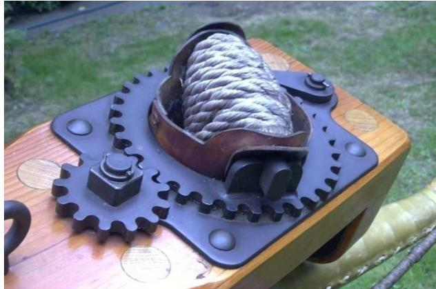
**Figura 18.** La matassa, il quadro per il precarico e il nottolino di arresto in un prototipo [R-9]
