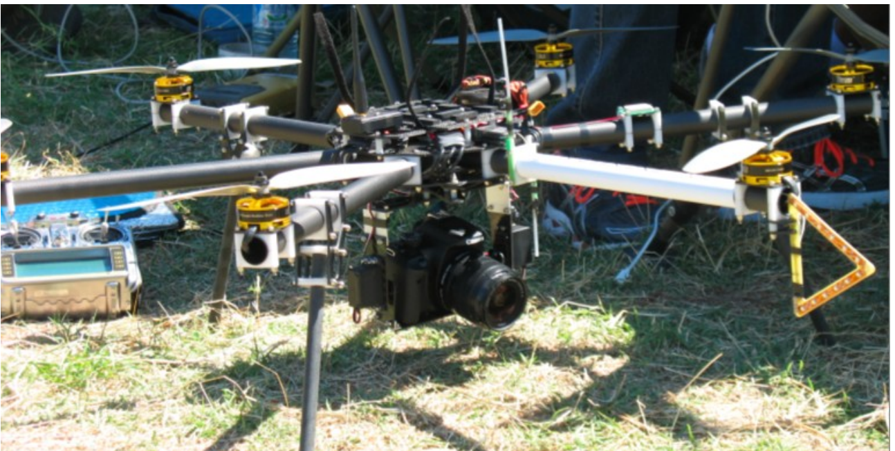
Fig.4 -Drone equipaggiato con camera orientata per una ripresa orizzontale, Gps e piattaforma inerziale.
