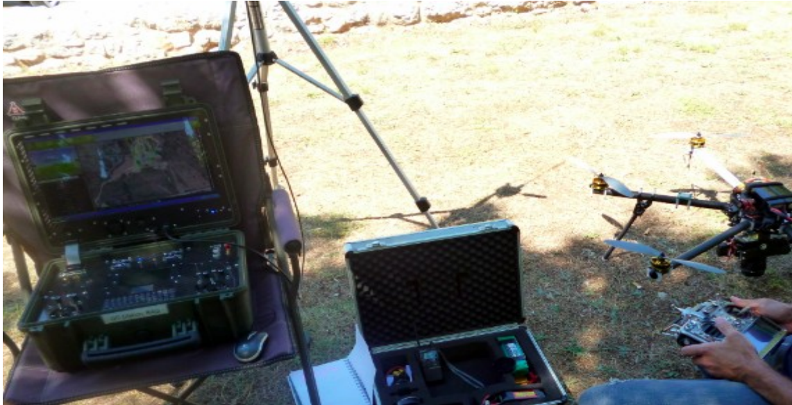
Fig.6- Dettaglio del sistema di controllo degli apparati elettronici.
