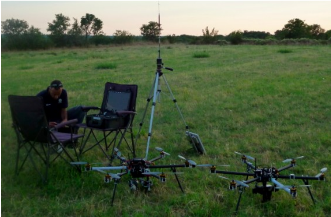
Fig.5- I due velivoli UAV nell'ambito delle operazione di collaudo: i due droni, uno per una ripresa nadirale all'oggetto, l'altro per l'acquisizione orizzontale, stazione master del Gps e sistema di controllo degli apparati elettronici.
