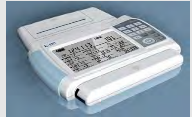
Figura 7.23. In basso: Apparecchiatura portatile per la lettura automatica degli stick (strisce reattive)
