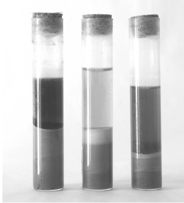
FIG. 3.5.2. - Effetto della sedimentazione di terreni dispersi in fiale
