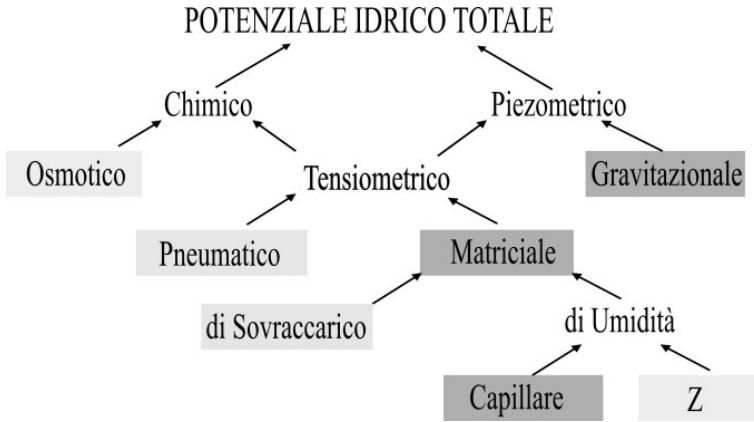
FIG. 6.1.1. - Diagramma che illustra le diverse componenti del potenziale idrico totale di un terreno
