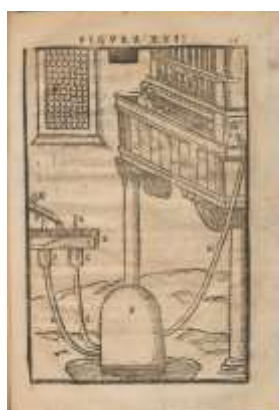
Fig. 2 Uno schema di organo idraulico nel quale l'aria viene pompata da uno stantuffo mosso a mano in un cilindro dove la pressione viene mantenuta costante dal livello dell'acqua (Moretti), a destra un organo del 288 d.C. di Aquincum, Budapest (Museo di Aquicum) e ricostruito con i pezzi originali, e una immagine su di un mosaico del periodo romano di Nenning
