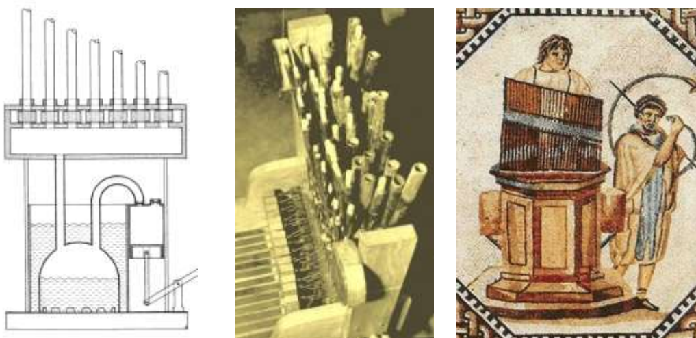
Fig. 2 Uno schema di organo idraulico nel quale l'aria viene pompata da uno stantuffo mosso a mano in un cilindro dove la pressione viene mantenuta costante dal livello dell'acqua (Moretti), a destra un organo del 288 d.C. di Aquincum, Budapest (Museo di Aquicum) e ricostruito con i pezzi originali, e una immagine su di un mosaico del periodo romano di Nenning
